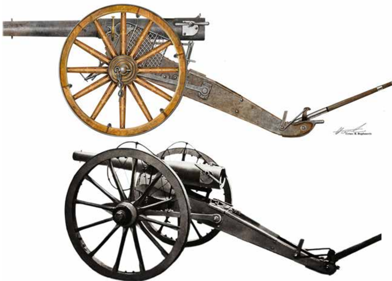
Poljski četvorofuntovni top (87 mm) sistema Krupp M1867.
