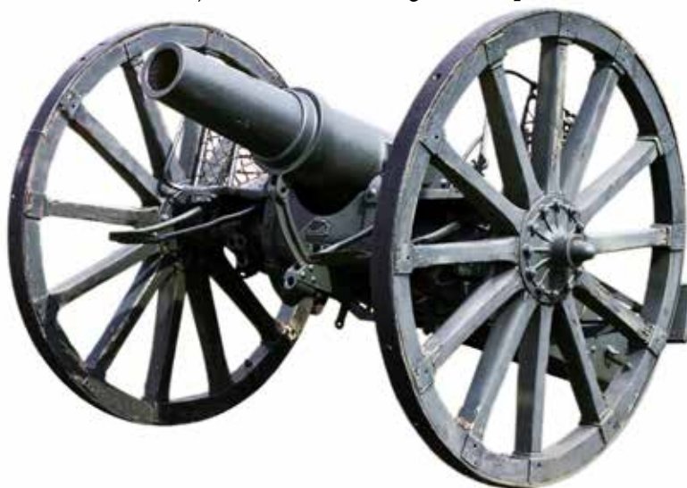
Zaplijenjena turka haubica 120 mm M1897 sistema Krupp.
