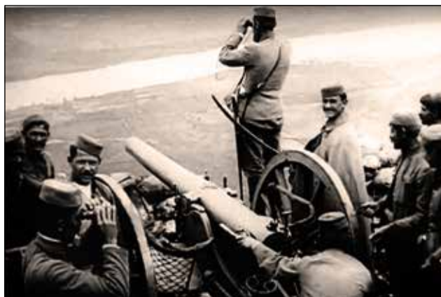
Crnogorski bronzani (Uhacijusov sistem) poljski top 87 mm BRC Mod.1880/95 na položaju kod Skadra.
