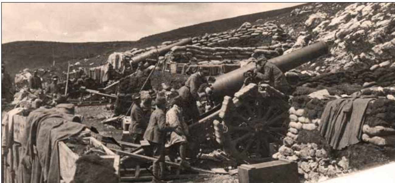
Italijanske haubice 21 cm M1889 na borbenom položaju. Na točkovima oruđa montirane su papuče – gusenice sistema Bonagente .
