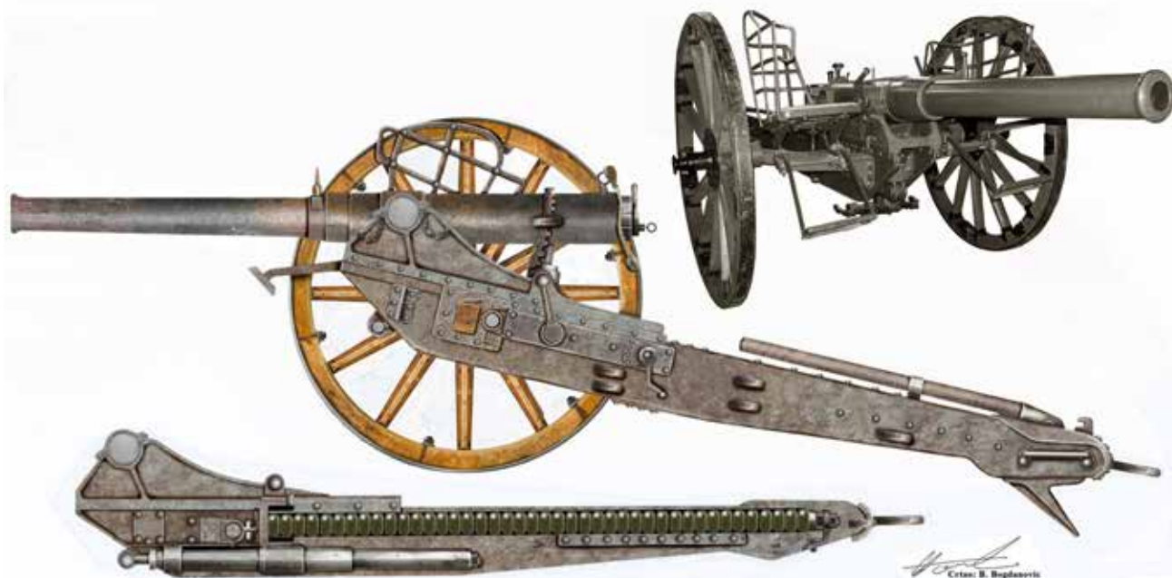
Poljski brzometni top 3-djujma (76,2 mm) M1900 (трехдюймовая полевая скорострельная пушка обр. 1900 года), proizvodnja Путиловский завод.
