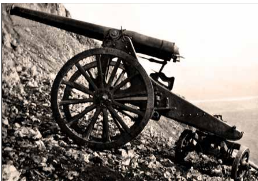
Dugi top 120/25 M1887 na lafetu C/73 sa transportnim podvozom.
