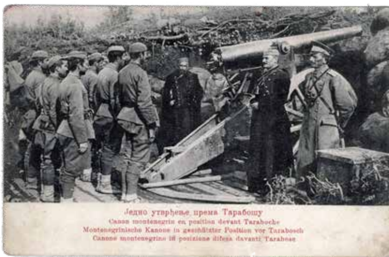
Top 120 mm BR Mod. 1887 na lafetu C73 na položaju prema Tarabošu.
