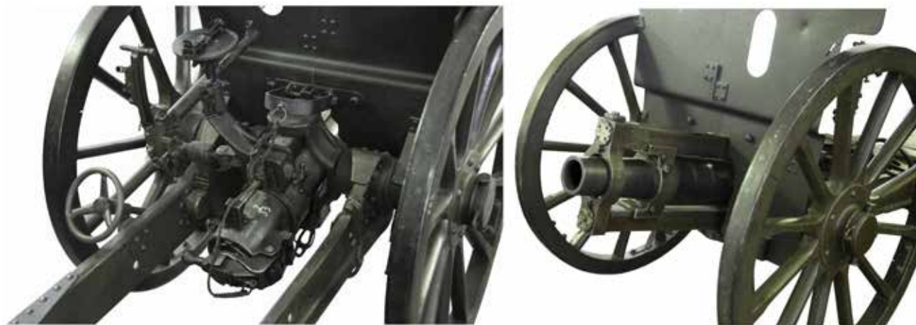
Detalji zadnjika sa zatvaračem i prednjeg dela brdskog topa M1904.
