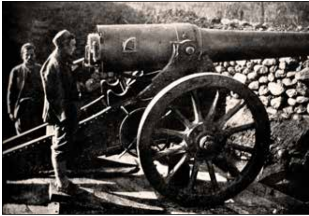
Italijanska opsadna haubica 21 cm GRC Mod.1889 na položaju kod Taraboša.
