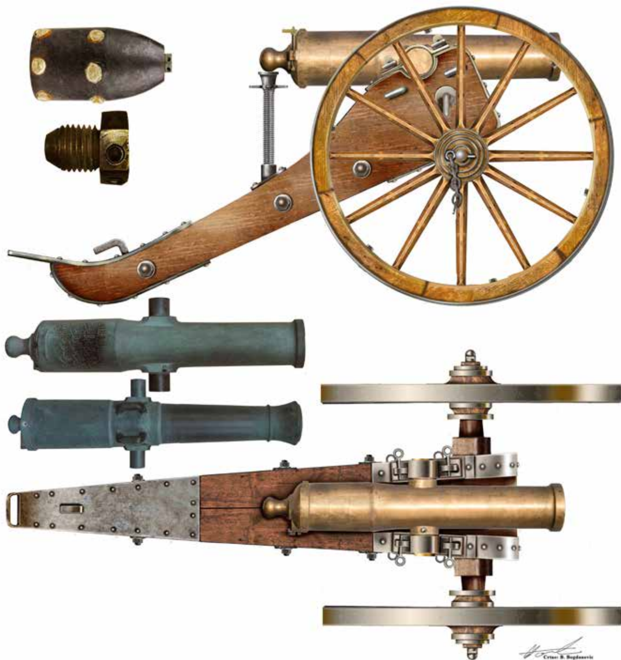
Izgledi granate, tipova cijevi i brdskog spredpunećeg žlebljenog četvorofuntovnog (85 mm) topa La Hitte M1858/63.
