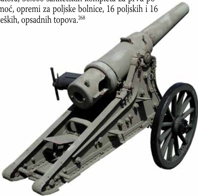
Izgled topa-haubice 15 cm M1877 sa zatvaračem u otvorenom položaju.
