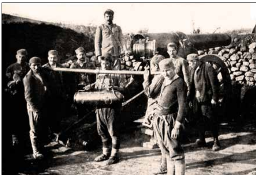
Priprema granate za punjenje opsadne haubice 21 cm GRC Mod.1889.
