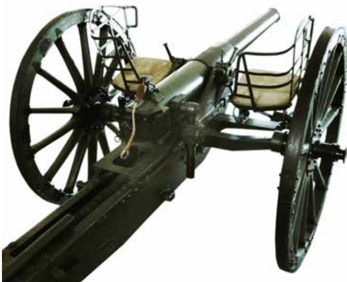
Pogled na zadnjak topa M1900 sa zatvaračem i užetom za aktiviranje upaljača.
