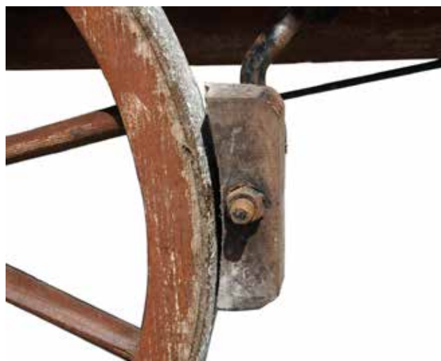
Frikciona blokada (kočnica, backenbremse ) točkova radi smanjenja trzanja.
